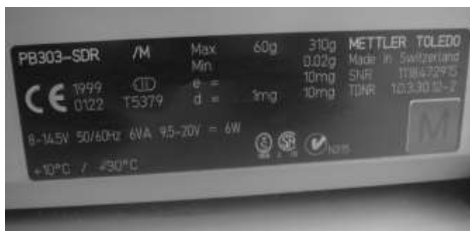
Figure 2 : Données d'identification et caractéristiques techniques figurant sur la plaque signalétique de la balance
